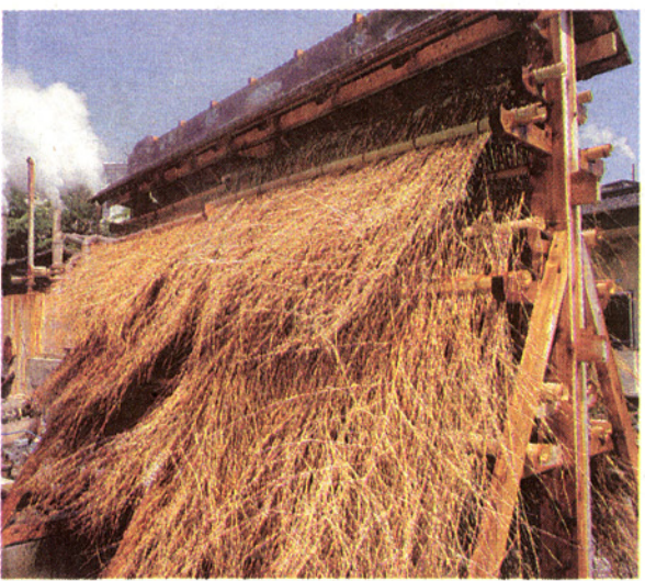
■熱湯の源泉を特産の竹を使い適温に冷却する装置。ホテルに掲示された温泉カルテ(別府市鉄輪温泉)
